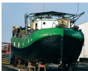
Décalage et mise sur tins d'un bateau-logement
